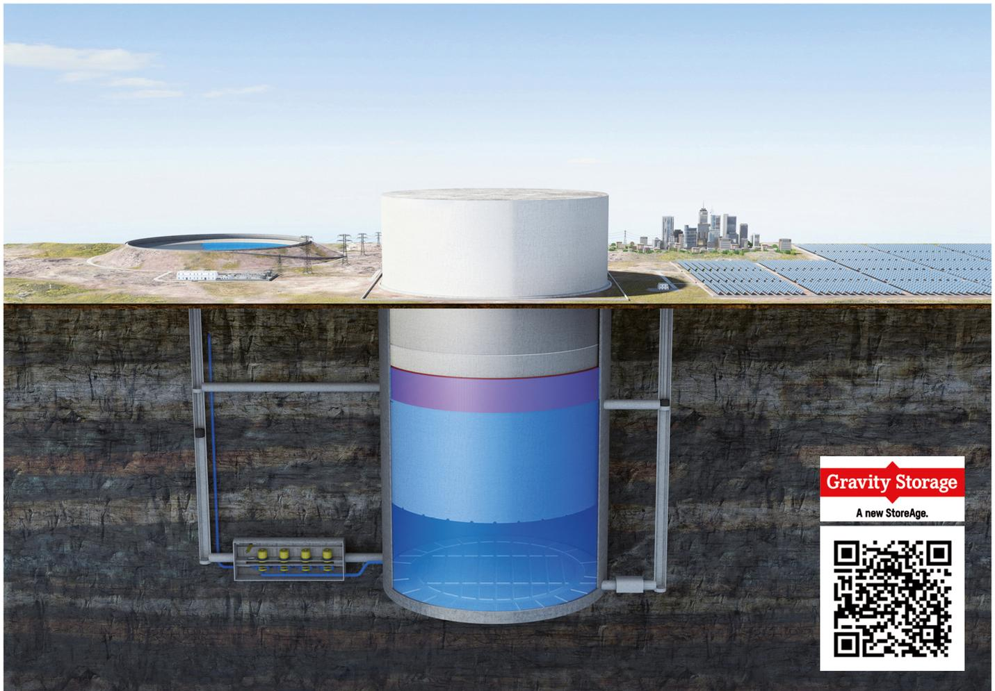
Gravity Storage (Lageenergiespeicher): Ein aus seiner natürlichen Umgebung herausgelöster Felskolben wird mit Wasserdruck angehoben, bei Strombedarf wieder abgelassen und das Wasser in Turbinen eingeleitet. Quelle: Heindl Energy GmbH
