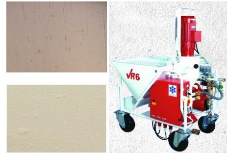
Beispiel: Putzmaschine, unterschiedliche Oberflächenqualität des applizierten Putzes
